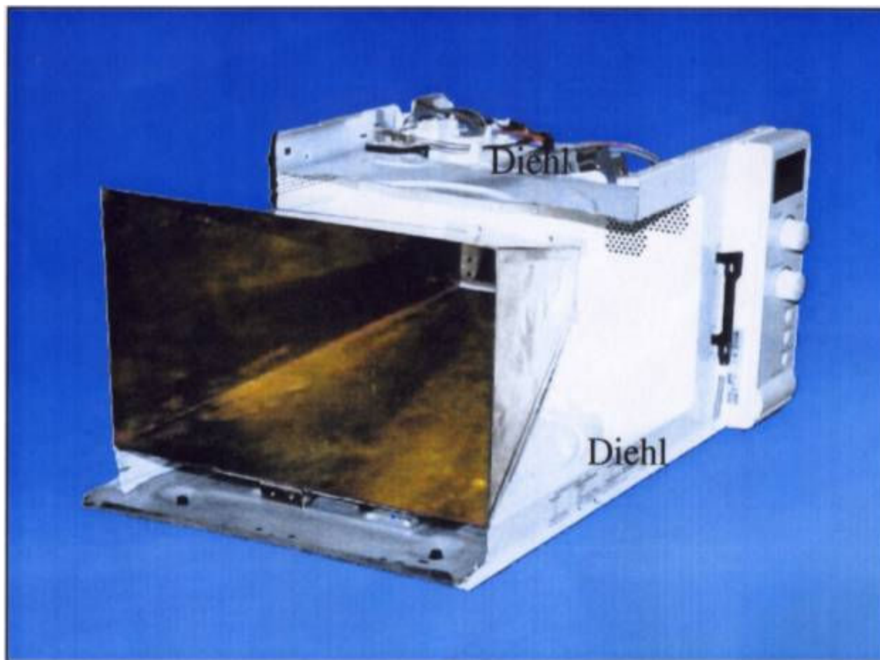
Adaptacja kuchenki mikrofalowej na improwizowaną broń HPM
